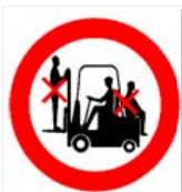
Afbeelding: Verbodsbord meerdere personen op heftruck
